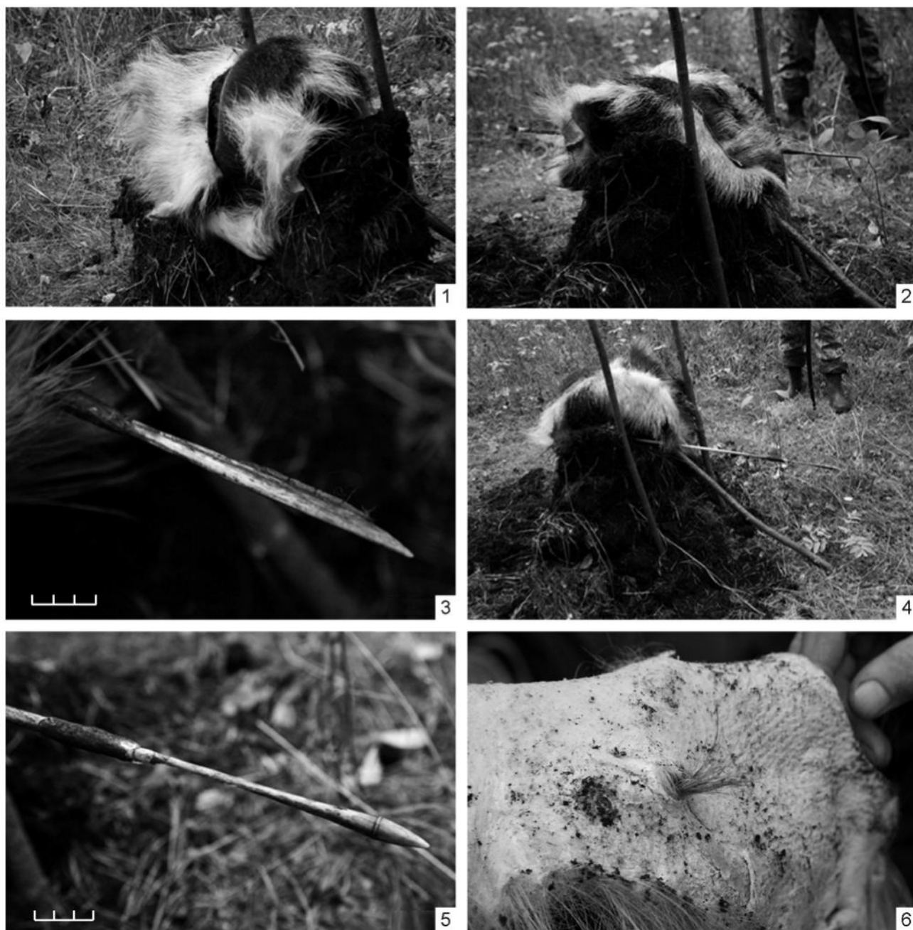
Рис. 7. 1 — мишень из блоков торфа, покрытая шкурой кабана; 2 — мишень, пробитая стрелой с вкладышевым наконечником; 3 — вкладышевый наконечник стрелы, пробивший мишень; 4 — мишень, пробитая стрелой с наконечником с биконической головкой; 5 — наконечник стрелы с биконической головкой, пробивший мишень; 6 — пробоина на шкуре от наконечника с биконической головкой
